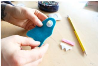
Optional: Bevor du das LED-Licht einsetzt, kannst du von Hand ein kleines Kreuz nähen, um die Stelle zu markieren, an der der Knopf gedrückt werden soll, damit die LED leuchtet.
