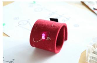
13) Schließe den Druckknopf und überprüfe, ob der Stromkreis funktioniert.
